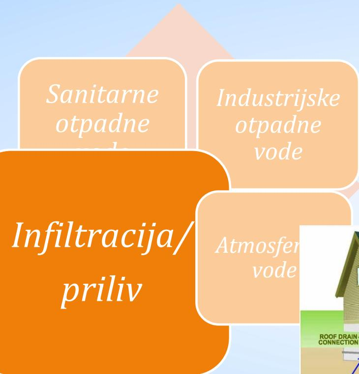
**Poreklo:** Infiltracija je voda koja ulazi u sisteme prikupljanja (kanalizacioni sistem) kroz više tačaka, uključujući defektne cevi, dotrajale spojeve na cevima, šahtove itd.
